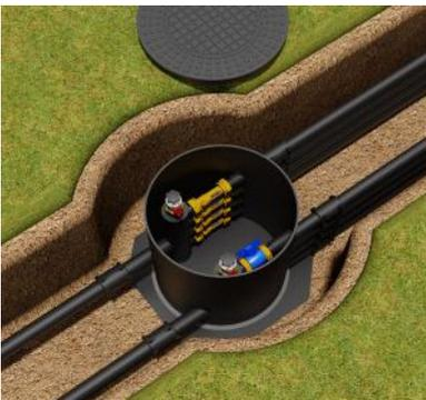
Der Wärmepumpenanschluss ist bei dem vertikalen Einbau immer gegenüber der Kreisanschlüsse(180°). Um die Einschweißung normgerecht auszuführen, muss der WP- Anschluss 2 Dimensionen unter dem Sammlerdurchmesser ausgeführt werden!
