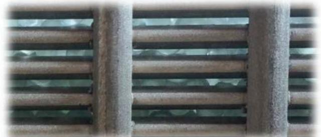
NRTEC MP-System – Innenfilter mit dahinterliegender Glasperlen-Packung
