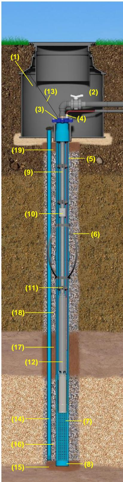
**Einen Brunnenausbau mit PVC Voll- und Filterrohr ist der Standardausbau für die meisten Brunnen. Entsprechend der, in der zur Wasserentnahme vorgesehenen Schicht, vorhandenen Geologie werden Schlitzfilter aus PVC eingesetzt, deren Schlitzung entsprechend der Korngrößen des natürlichen Materials der vorgesehenen Schicht ausgelegt und ausgeführt wird.**
