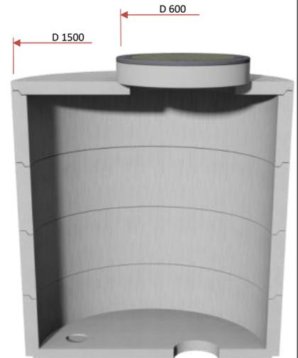
Bei Lieferung als einbaufertiger Schacht mit allen vorab integrierbaren Bauteilen bzw. wenn Brunnenkopf bzw. Schachtabdeckung gemeinsam dem Schacht bestellt werden, können diese im Werk direkt in den Schachtkörper mit eingegossen werden.
